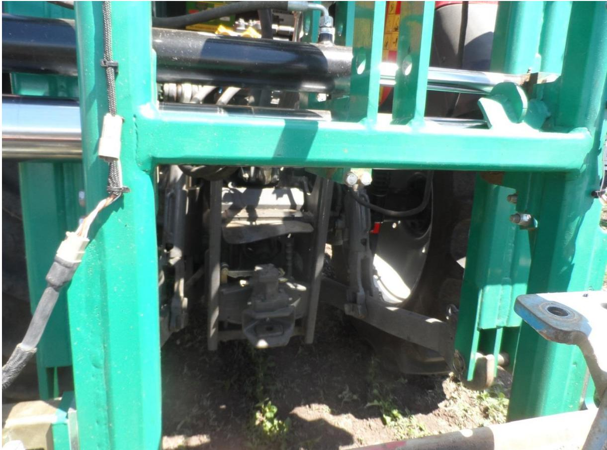
Einsatz eines Verschieberahmens z.B. beim Fräsen von Kartoffeldämmen: Zapfwellendurchgang beachten!
