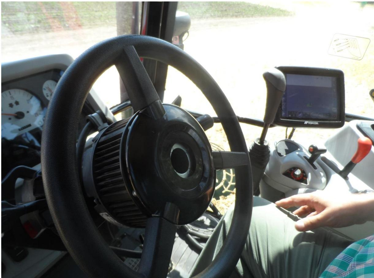
RTK System mit Lenkautomat zur exakten Anlage der Versuchspartzen
